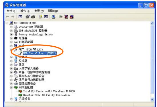
注意：若完成后端口位置未显示，需右键单击找到“USB Serial Converter”重复更新驱动。
